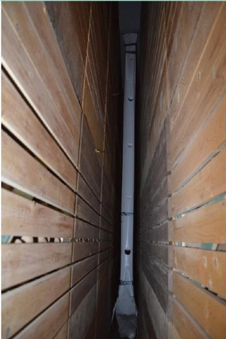
Abb. 14: Druckbelüftung: Horizontale og vertikale Luftverdeling etter installasjon av ein foliestreife i området av den 4. kisten, (Luftfartshastighet ved sidestrukturåpningar i kistene), Stappelengde/-høgde: 19/5 (Abbildungen: Verfassar)
