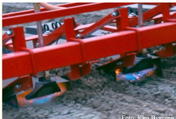
Figur 7. Propanbrenner er vanlig til løk og gulrot. Må kombineres med anna redskap
