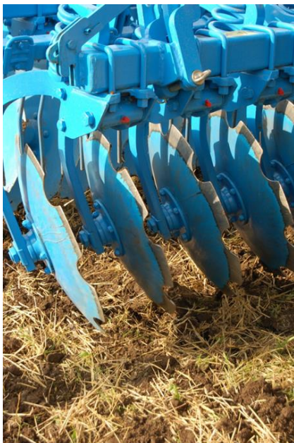
Figur 4 Skålharv er godt egna til å kutte utløpere av kveke og åkerdylle
