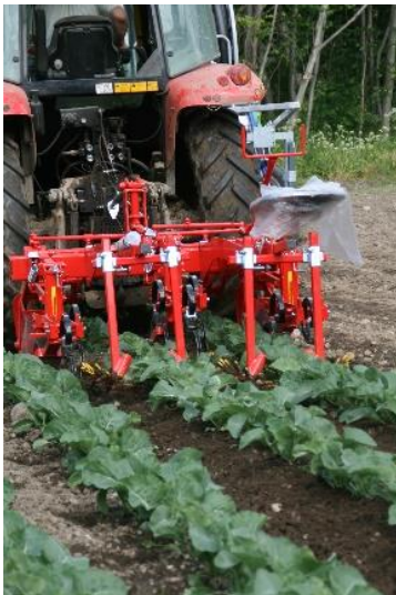
Figur 6. Fingerhjul fungerer veldig godt inntil og mellom planterækker i planta kulturer
